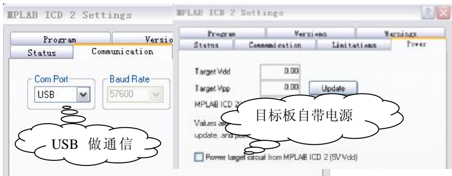
图 5-3 设置通信端口和目标板供电方式
